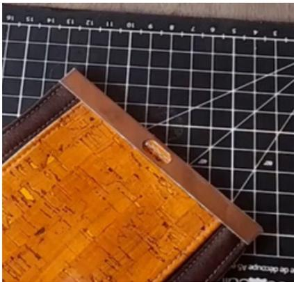
2 - On positionne la partie avant, et on marque l'emplacement du trou du fermoir à l'aide d'un stylo
